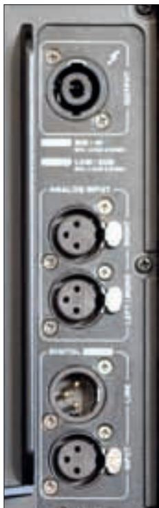
Auch digitale Ein- und Ausgänge im AES/EBU-Format bieten die Endstufenmodule.
